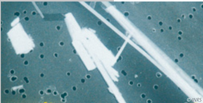
Fibres et fibrilles d'amiante vues au microscope électronique à transmission analytique
