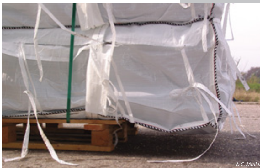
La disposition 168 ne s'applique pas car la longueur de la palette est inférieure à celle des plaques d'amiante-ciment
