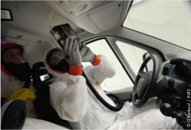
Prélèvement d'air dans la cabine du véhicule de chantier
