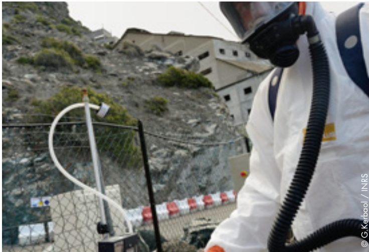
Prélèvement d'air en bordure de site, au niveau de la base sanitaire
