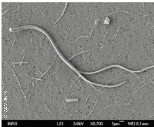
Fibres de chrysotile vues par microscopie électronique à balayage (MEBA)
