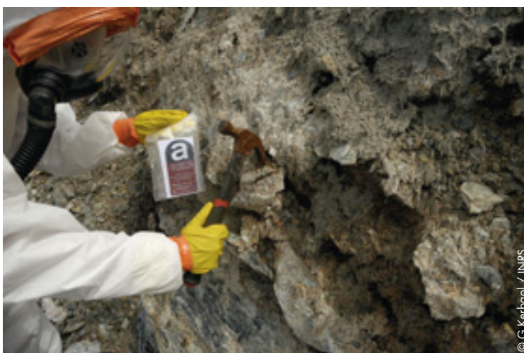
Géologue effectuant un prélèvement de roche amiantifère
