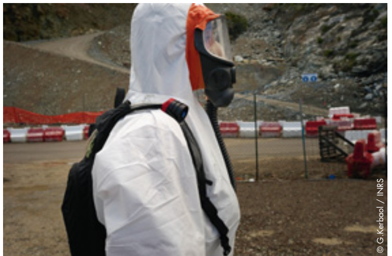
Opérateur équipé d'un système de prélèvement pour le contrôle au poste de travail des niveaux d'empoussièrem
