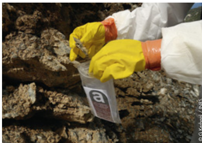
Géologue effectuant un prélèvement de roche en vue d'une analyse au microscope
