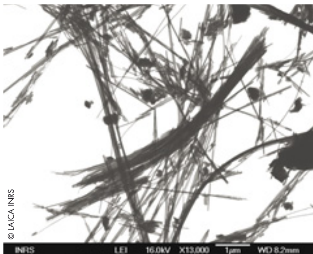
Fibres de chrysotile observées par microscopie électronique à transmission analytique (META)
