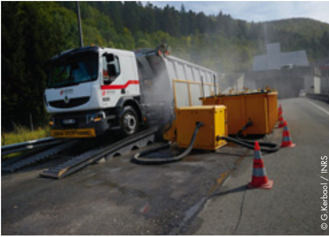
Rotoluve mobile avec système d'aspersion de la benne en sortie de site
