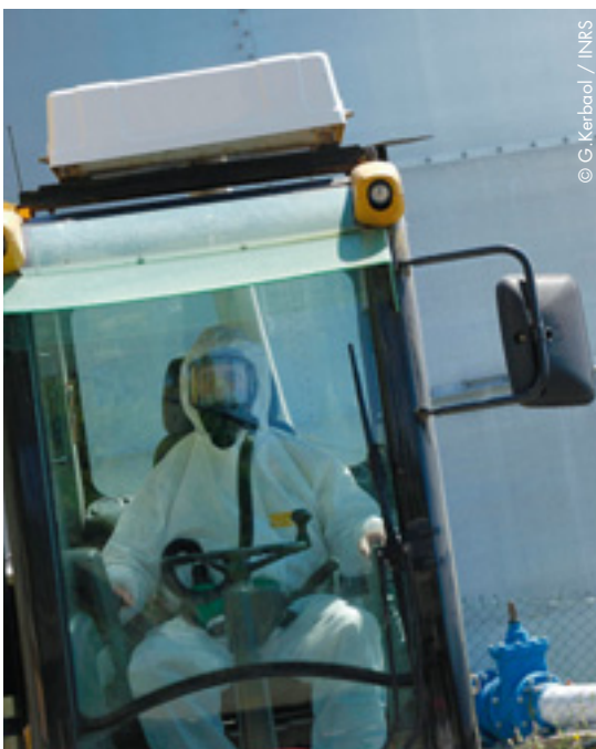
Conducteur d'engin équipé de protection respiratoire, engin équipé d'un système de filtration et de pressurisation de l'air
