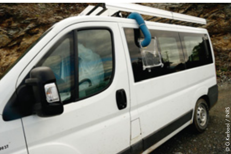
Véhicule de transport du personnel sur le site équipé d'un système de filtration de l'air et d'apport d'air neuf filtré dans l'habitacle
