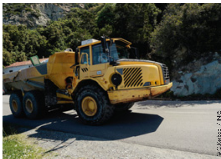
Engin de chantier équipé d'un système de pressurisation d'air filtré fixé sur le toit de la cabine
